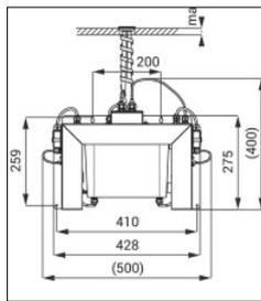
Mehrplatz Edelstahl-Sensor-Waschtischseifenspender; 2 - 6 Plätze, Peristaltische Pumpe pro Platz, 6 Ltr. Seifentank, Füllstandsleuchte; integrierter 24V-Trafo. Seifenzuleitungsschlauch bis max. 2500 mm Entfernung Seifenspender zu Pumpenankeinheit.
